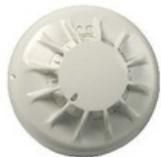
Le FC460H est un détecteur de chaleur adressable, flexible et économique, qui possède toutes les caractéristiques des détecteurs FireClass. Le FC460H renvoie la température à la centrale FireClass ce qui permet de mettre en œuvre différents modes de détection. Il utilise une thermistance de haute qualité avec une très faible masse thermique. Cela permet aux détecteurs de fournir une détection rapide et précise de la température ainsi qu'une détection de la chaleur.
