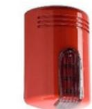
Sirène extérieure rouge autonome en ABS avec flash led rouge sur 24 VDC, conforme EN54-3, pression sonore 102 dBA à 1 m. 24V nominal, courant de charge max 0,5A. Dimensions H322 x L215 x P105mm.
