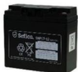
Batterie NP Sefica 12V-17Ah Pour application stationnaire ou rechargement cyclique Batterie au plomb rechargeable, étanche et sans entretien 2 pièces par boîte Dimensions (LxPxH): 181 x 76 x 167 mm Poids: 5,90 kg
